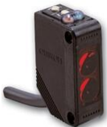
Figur 4_Omron E3Z, direkteavkjenning, 1m, DC, 3-leder, PNP, 2m kabel (trenger brakett).
