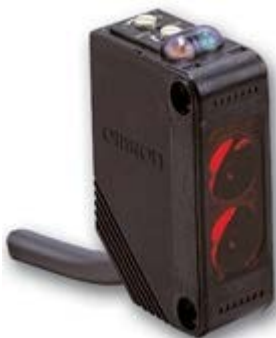
Figur 4_Omron E3Z, direkteavkjenning, 1m, DC, 3-leder, PNP, 2m kabel (trenger brakett).
