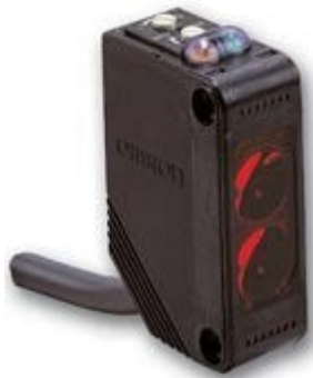
Figur 3 Omron E3Z, direkteavkjenning, 1m, DC, 3-leder, PNP, 2m kabel (trenger brakett).
